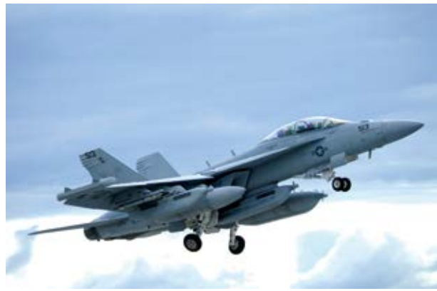
アメリカ海軍のEA-18G グラウラー。胴体下と主翼下および主翼端に取り付けた電子戦ポッドでさまざまな電子妨害をおこなう(写真:US Navy)
