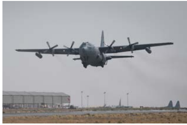
アメリカ空軍のEC-130 コンパスコール電子戦機。大きな機体にさまざまな機器を搭載し、さまざまな電子妨害をおこなう(写真:US Air Force)
